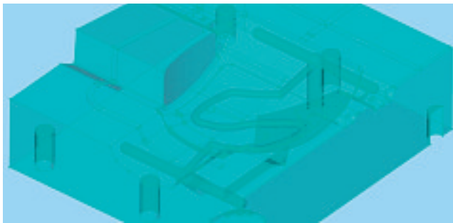
Mit OptiCool kann die Anzahl der Kanäle und deren Komplexität vom Bediener gewählt werden, wie hier im identischen Spritzgusswerkzeug mit einfachem (links) und aufwändigem Kühlsystem (rechts).
